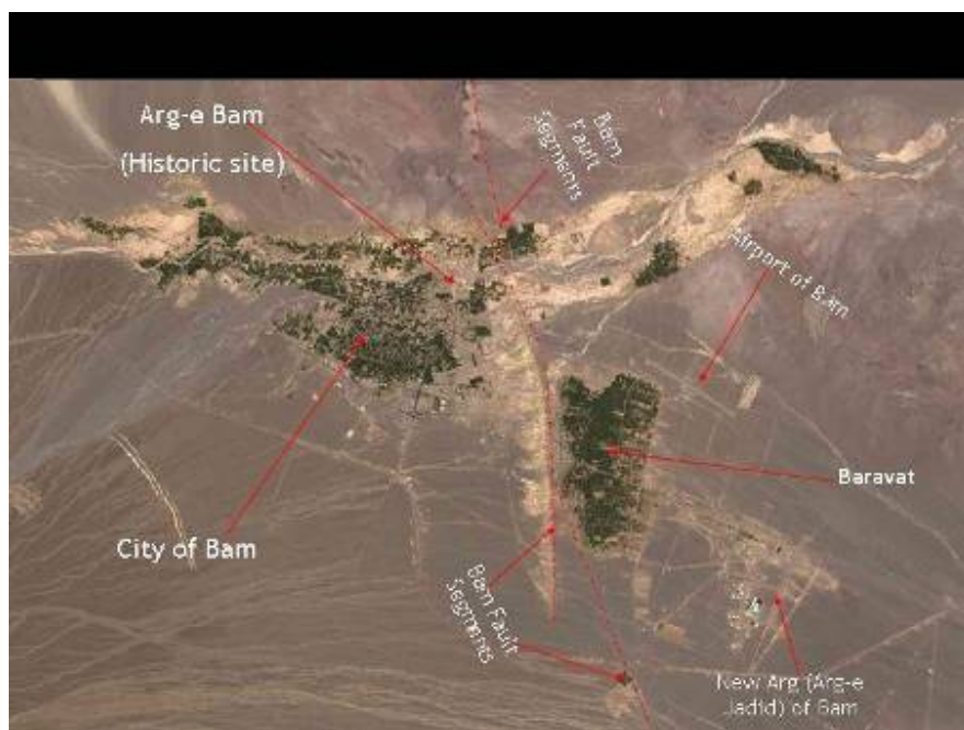
شکل (۲-۱۳): تصویر ماهواره ای تهیه شده توسط ناسا (یک روز پس از زلزله ۲۶/۱۲/۲۰۰۳) موقعیت پهنه رومرکزی و محلهای اصلی آسیب دیده از زلزله بم به همراه قطعات گسل بم در شکل نشان داده شده است.
