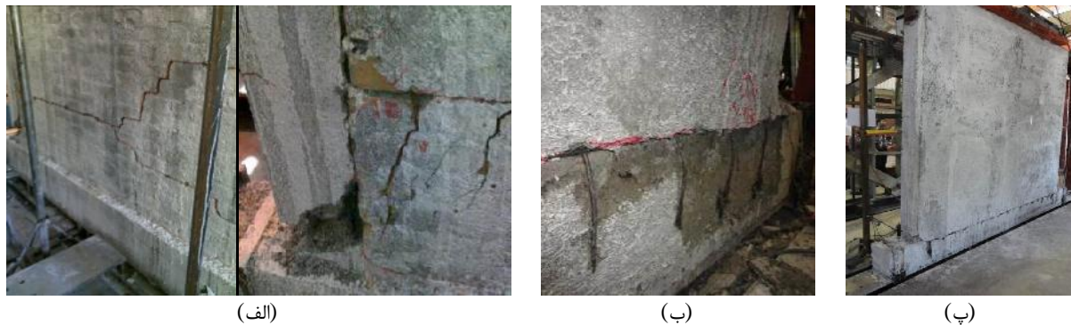
شکل ۷: حالت نهایی شکست نمونه های آزمایشگاهی الف: URM، ب: MRSFS، پ: MRPFS
