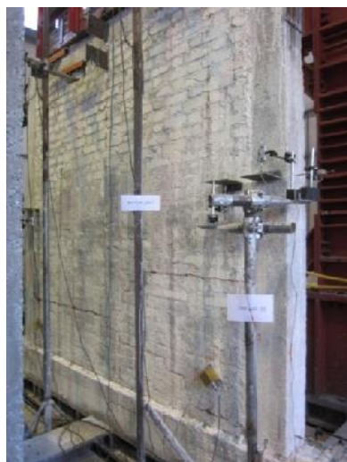
شکل ۷: شکست لغزشی دیوار غیر مسلح
