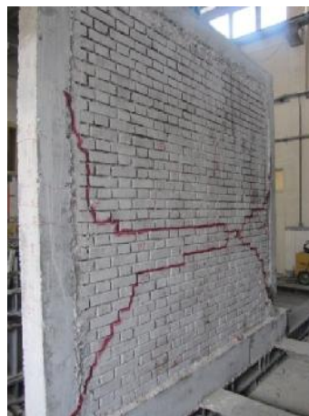
شکل ۱۴: شکست لغزشی دیوار آجر مجوف
