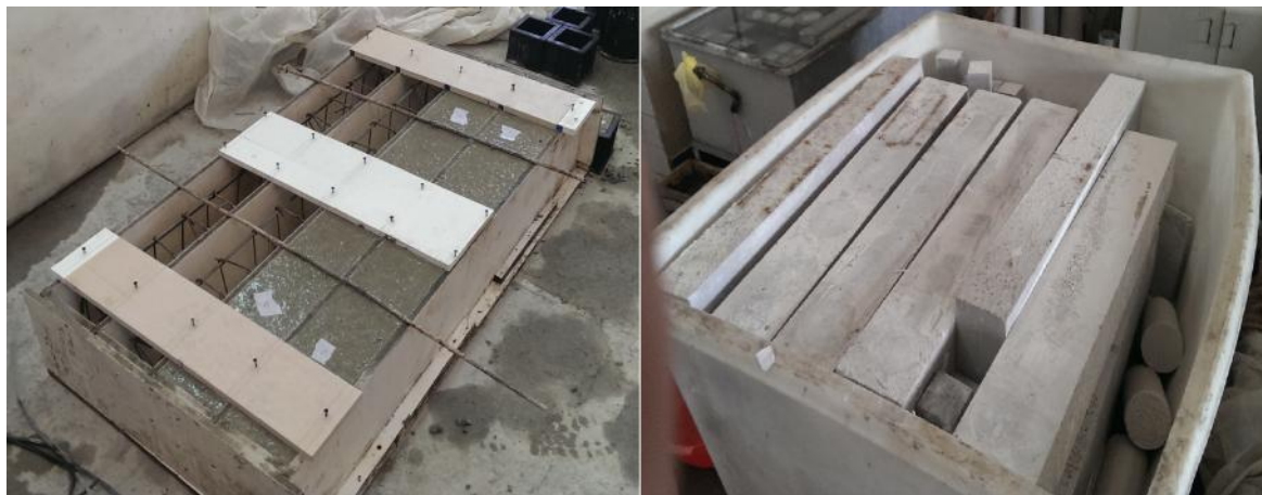
شکل ۱: بتن ریزی درون قالب ها و نگهداری نمونه ها درون استخر
