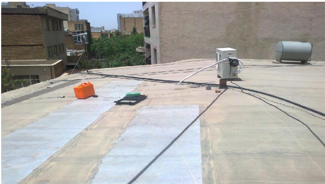
شکل ۱: دستگاه لرزه‌نگار و ثبات بر بام ساختمان شماره ۱
