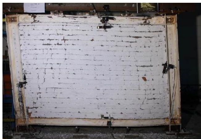
شکل ۸: مقایسه پخش ترک‌ها در مدل تحلیلی و آزمایشگاهی
