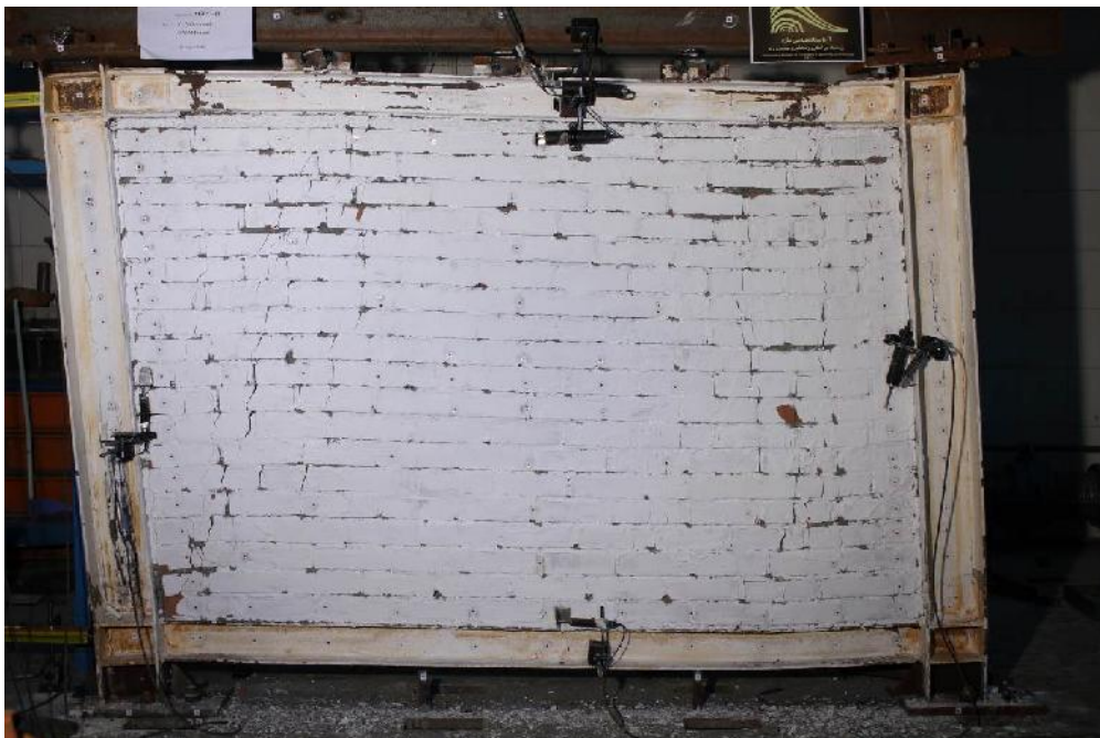
شکل ۵: بخش ترک‌ها در مدل آزمایشگاهی در دررفت ۷٪
