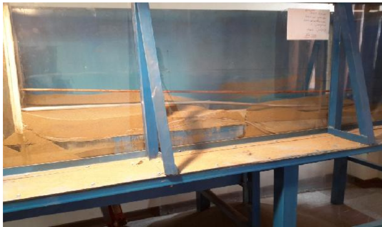
شکل ۴: تغییر شکل لوله‌ها در آزمایش اول بعد از اعمال گسلش
