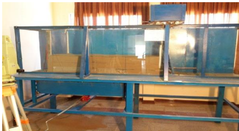
شکل ۲: تصویر واقعی دستگاه شبیه ساز گسلش معکوس
