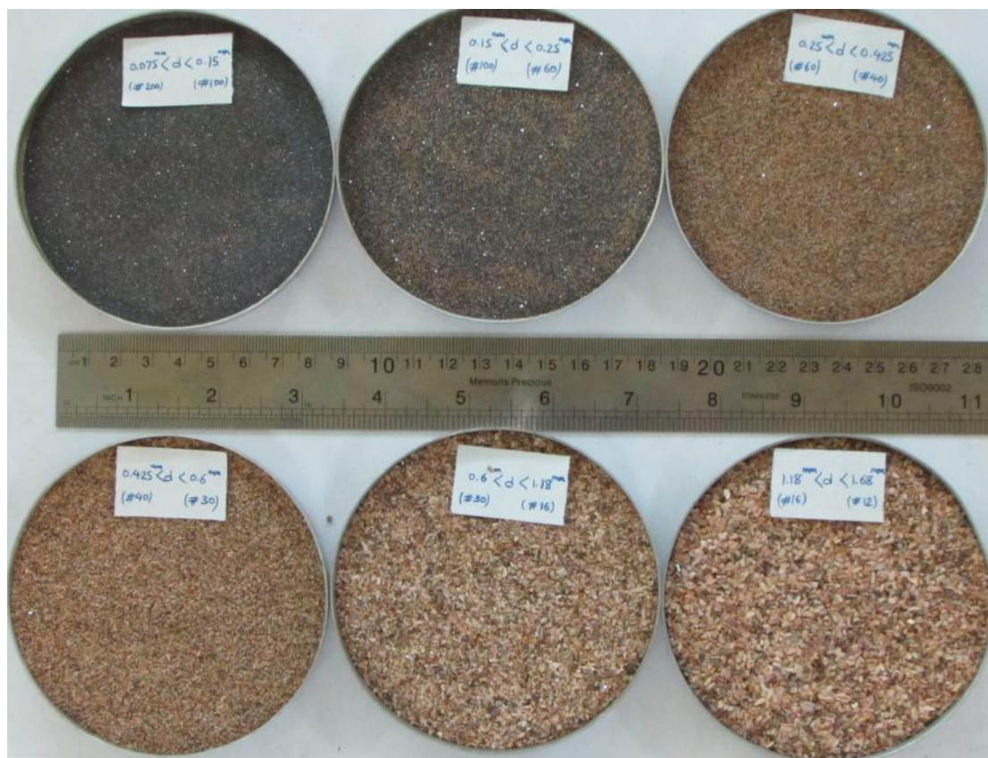
شکل ۳: تصویر ماسه جزیره هرمز در اندازه الک های مختلف
