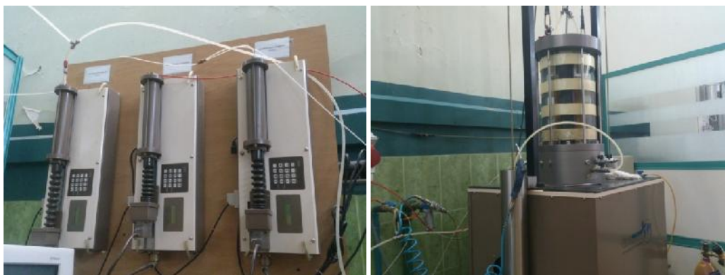
شکل ۴: تصاویری از دستگاه استوانه توخالی دانشگاه علم و صنعت ایران (راست: بخش اصلی، چپ: کنترلرهای اعمال فشار)
