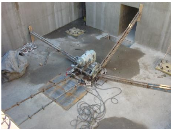
شکل ۳: الف) پی میز لرزان پژوهشگاه ب) دستگاه لرزاننده نصب شده روی پی
