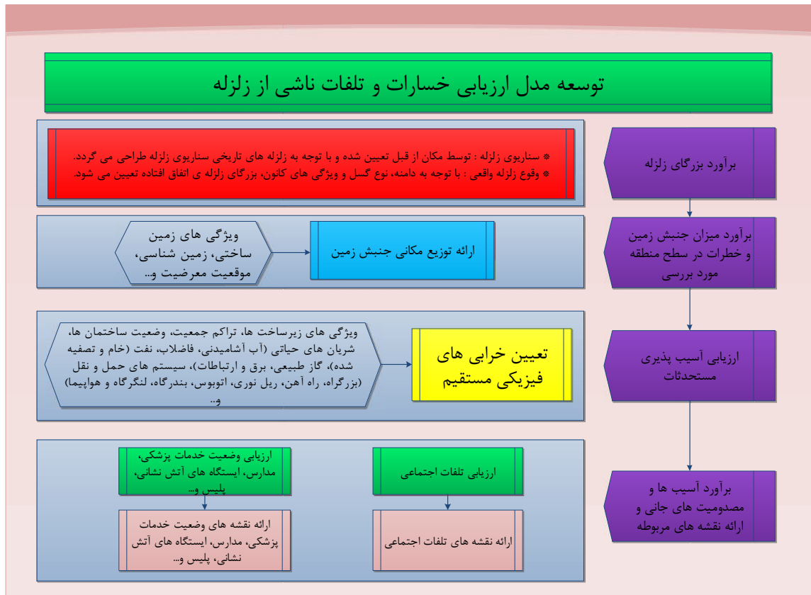
شکل ۱: کلیات مدل ارائه شده به منظور ارزیابی خسارات و تلفات ناشی از زلزله
