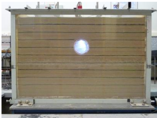
شکل 1: مدل آماده‌شده بر روی دستگاه میز لرزه قبل از انجام آزمایش
