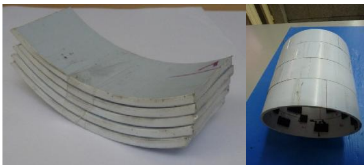
شکل ۳: سمت چپ، قطعات آماده شده پوشش تونل؛ سمت راست، بخشی از تونل سگمنتی مدل شده
