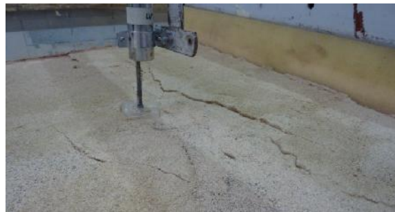
شکل ۷: ترک‌های ایجاد شده در سطح زمین در اثر ایجاد سطوح گسیختگی
