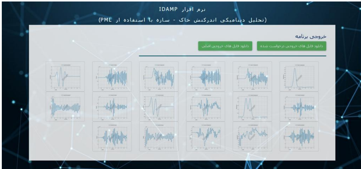
شکل (۲-۳-۲): صفحه نمایش نتایج خروجی به صورت مجزا برای تک تک درجات آزادی تعیین شده
